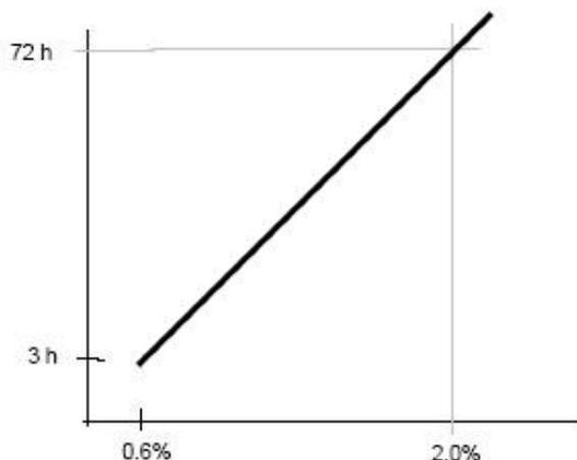
Дозировка, которая рекомендуется для обеспечения регулирования процесса гидратации в течение от 3 до 72 часов, составляет 0,2-1,0 % от веса цемента. Нужно производить специальную дозировку в зависимости от типа цемента, предназначения смеси, температуры окружающей среды и требуемого времени.
